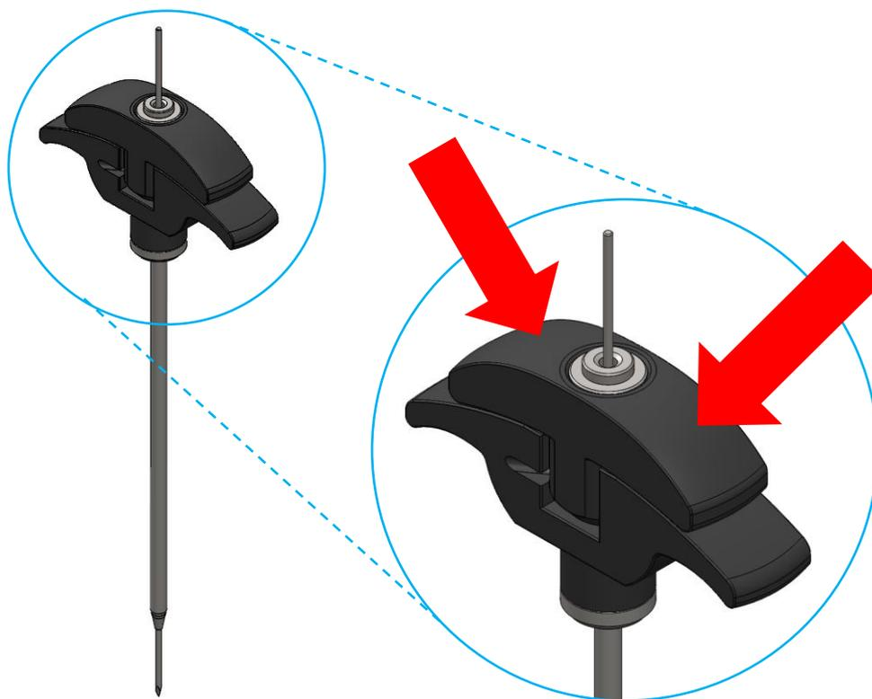
**ATENÇÃO:** Impactações realizadas diretamente no Cabo da Cãnula Externa podem causar fratura do cabo.
