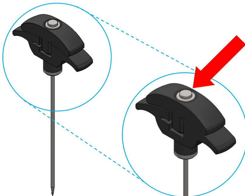
**ATENÇÃO:** Impactações realizadas diretamente no Cabo da **“Cânula Iniciadora de Acesso Percutâneo”**, podem causar fratura do cabo.
